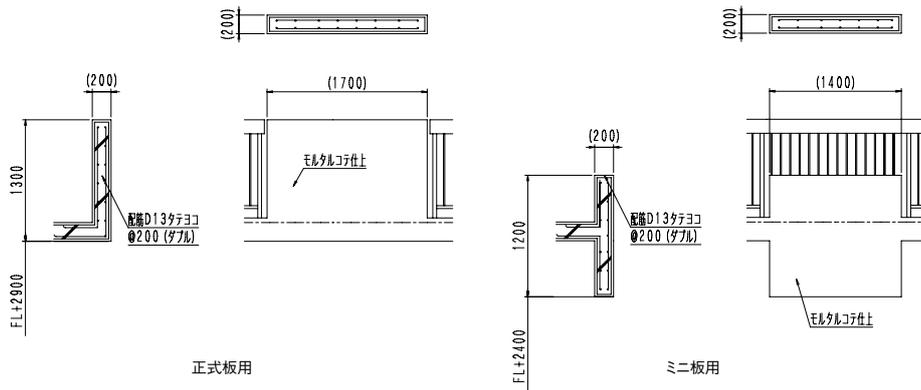
壁面バスケット用 鉄骨補強参考図 (建築工事に含まれます)
