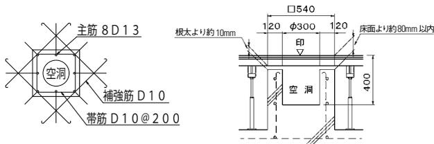
床仕上がり後、床金具に合わせて床材を切り取ってコンクリートを流し込んで、床金具を埋め込みます。
