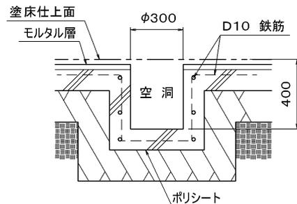
塗床施工前に床仕上面に合わせて床金具をコンクリートで埋め込みます。
