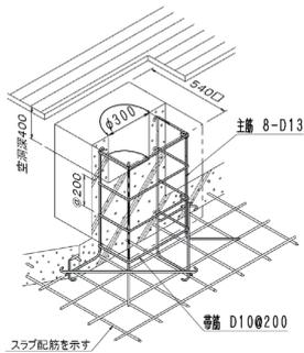
体操器具、低鉄棒、バレーボール支柱、テニス支柱等は、床工事の前に床下基礎の施工が必要です。また将来、上記の器具設置の計画があれば、床下基礎を施工しておく必要があります。
